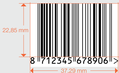
Bij de nominale afmetingen van de EAN-13 barcode (100%)
